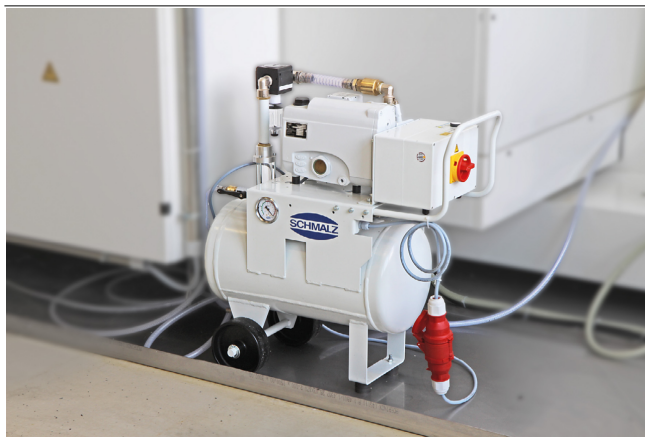
Unidad de vacío VAGG para la generación de vacío en el mecanizado con taladrina
